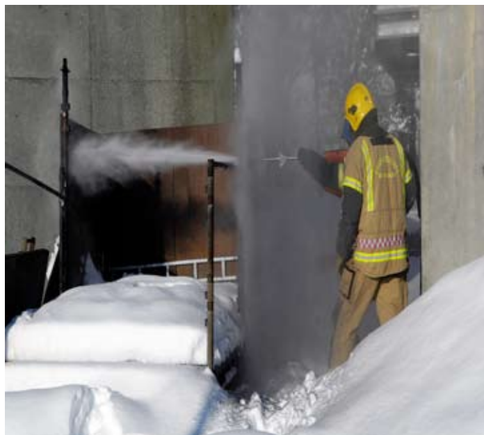
Hull i vegg: På få sekunder har den kraftige vannstrålen fra skjæreslokkeren klart å sprute seg vei gjennom solid metall.
