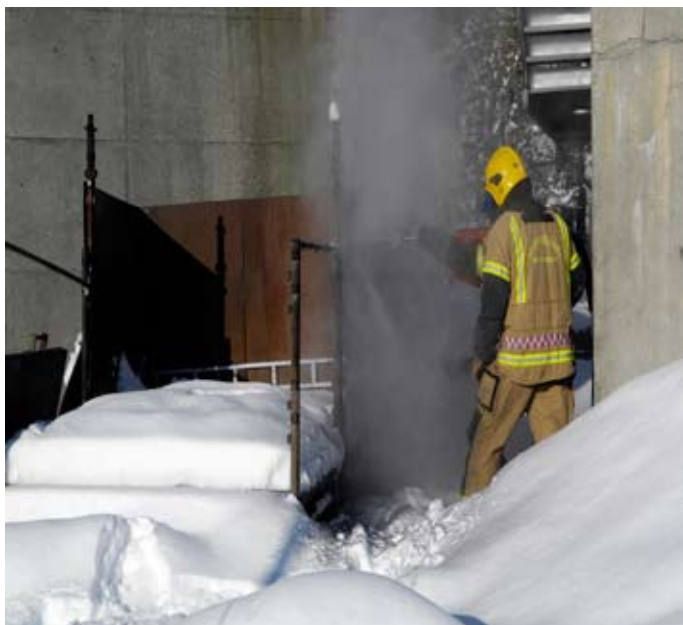
Hull i vegg: På få sekunder har den kraftige vannstrålen fra skjæreslokkeren klart å sprute seg vei gjennom solid metall.
